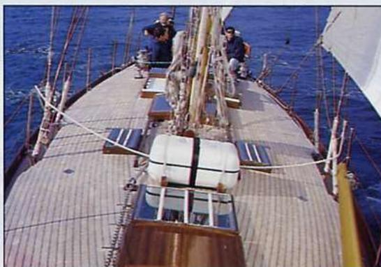
Lo scafo è interamente in legno multistrato incollato con resine poliestere ed epossidiche. Il trattamento bicomponente superficiale richiede una manutenzione frequente ma non così "drammatica" come si potrebbe pensare.
